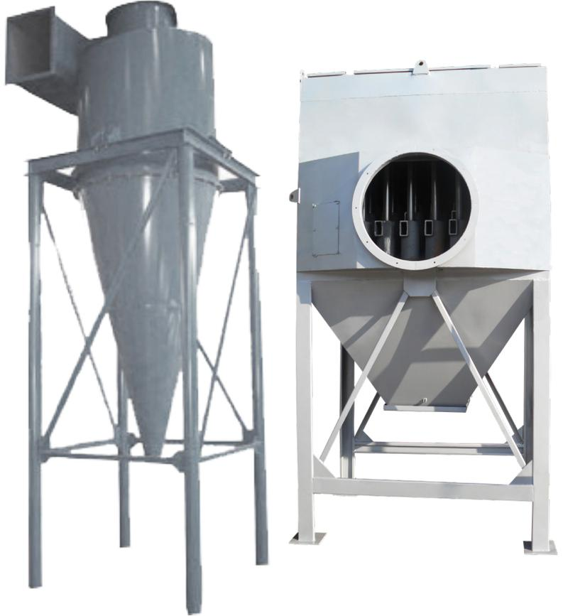
يُستخدم جهاز فصل الغبار والأتربة من النوع التقليدي في المنشآت الصناعية لفصل جسيمات الغبار الكبيرة عن الهواء وتقليل الحمل على مرشحات الهواء. يمكن أن يستوعب جميع جسيمات الغبار الكبيرة حتى 50 ميكرون، ولكن ليس تلك التي تقل عن 10 ميكرون.
