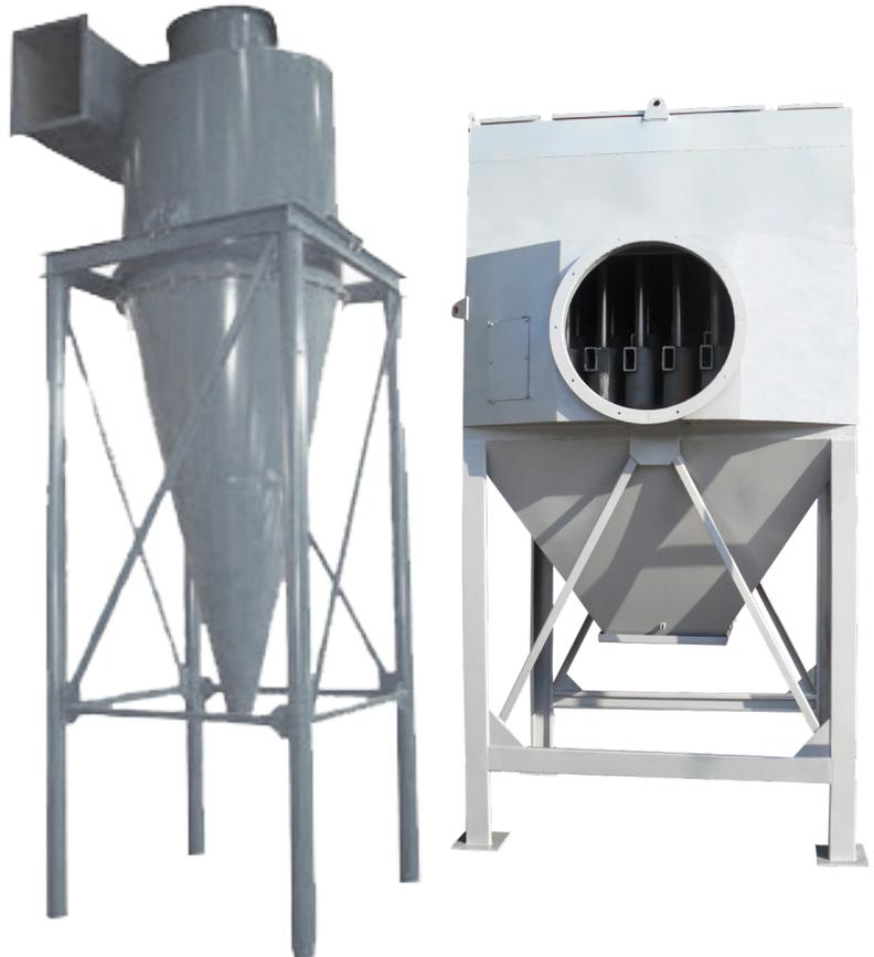
*Les préfiltrations cyclones sont utilisées dans les installations industrielles pour séparer les grosses particules de poussière de l'air et réduire la charge de particules de poussière provenant des filtres collecteurs. Les cyclones peuvent contenir toutes les grosses particules de poussière jusqu'à 50 $\mu$ , mais pas celles inférieures à 10 $\mu$ .*
